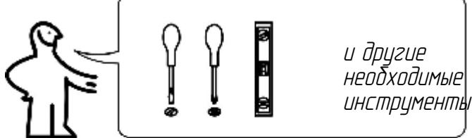
Для сборки подготовить следующий инструмент: две отвертки с крестообразной и прямой рабочей частью, молоток, угольник, рулетку, уровень.
