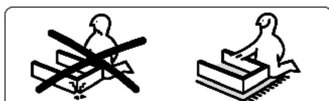
Чтобы избежать образования царапин, сколов, других повреждений деталей мебели и покрытия пола, застелите пол упаковочным картоном, например, или подходящим покрывалом. Не прилагать больших усилий при работе с молотком и применять подходящий прокладочный деревянный брускок.
